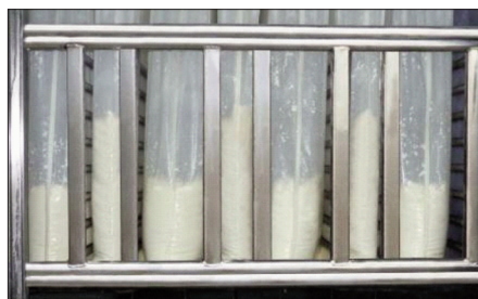
Рис. 4. Циклическое прессование и охлаждение творожного сгустка между секциями подвижного и неподвижного охладителя установки UTC
