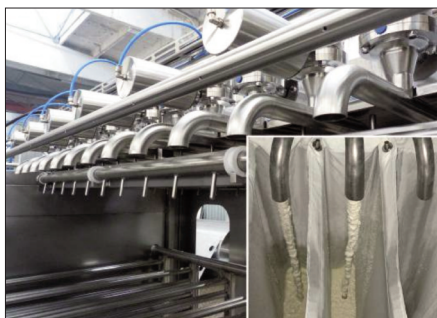
Рис. 3. Управляемый дозатор установки UTC. Розлив творожного сгустка
