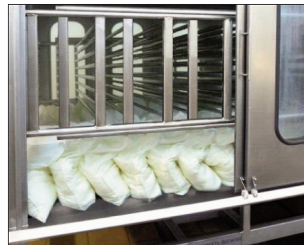
Рис. 5. Сброс фильтровальных элементов в установке UTC после достижения нормативных показателей продукта
