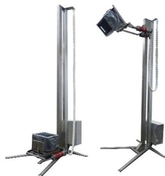
Рис. 4. Полуавтомат загрузочный АТЛ: исходное состояние (слева); рабочий режим
