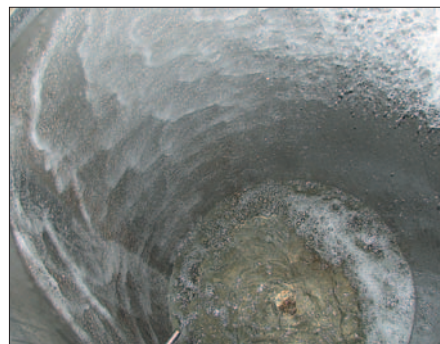
Рис. 8. Образование тонкой пленки на стенке деаэрата при подаче жидкости через специальный патрубок
